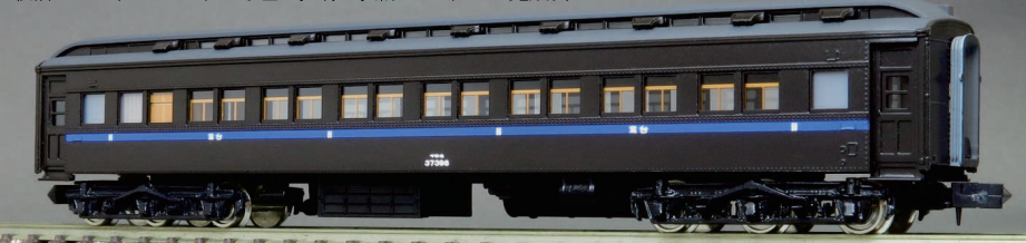
側窓の明るい色の部品は二重窓(夏季の開状態 色は個体差あり)
